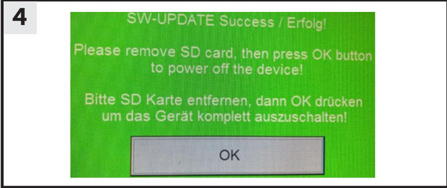
8. Sobald mit dem grünen Bildschirm angezeigt wird, dass der Prozess erfolgreich durchlaufen wurde, entfernen Sie die Speicherkarte aus dem Gerät und betätigen Sie „OK“ um den Prozess abzuschließen und das Gerät auszuschalten.
