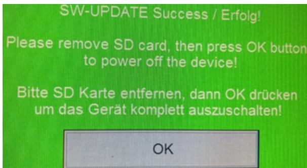
8. Jakmile se objeví zelená obrazovka, která indikuje úspěšnou instalaci, vyjměte paměťovou kartu, stiskněte „OK“ pro dokončení procesu a vypněte zařízení.
